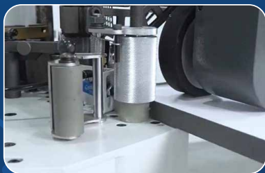
ДВЕ ОПЕРАЦИИ ЗА ОДНУ УСТАНОВКУ ДЕТАЛИ Кромление и фрезеровка свесов
