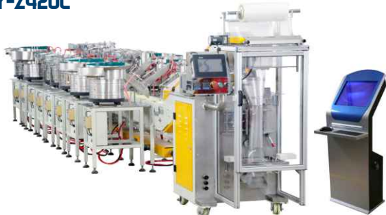
Линия фасовки фурнитуры Remexpacking FY-Z420C
