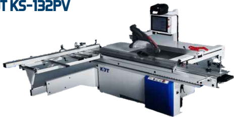
Форматно-раскроечный станок с ЧПУ KDT KS-132PV
